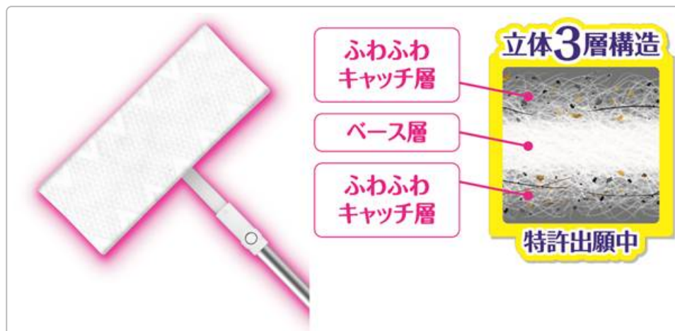
図：大王製紙「キレキラ！ワイパー」ドライ×ウェットシートの独自3層構造（上層と下層に「ふわふわキャッチ層」、中間に防水フィルム層を挟み込むことで片面の湿りが他面に染み出ない設計 ⑦ ）
