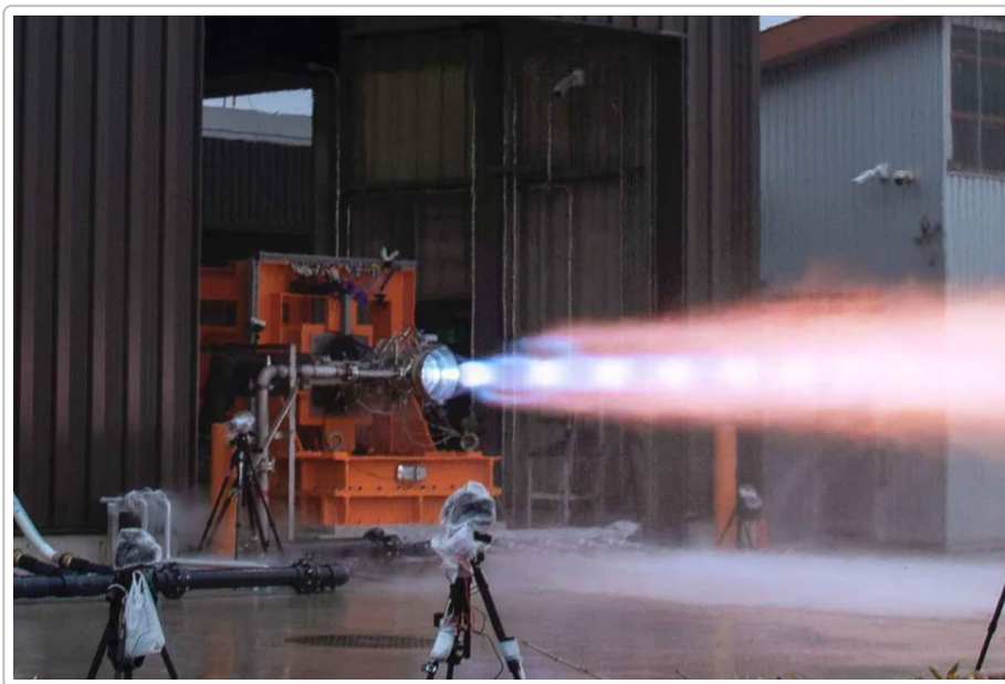
図3：IST社による液化バイオメタン燃料ロケットエンジン燃焼試験の様子（2023年12月7日、北海道大樹町） 48
