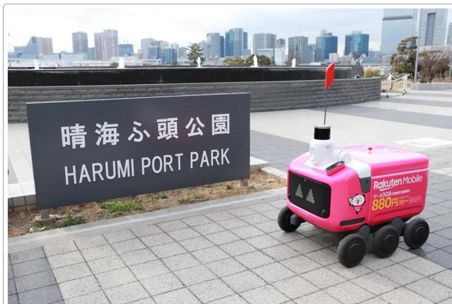
図： 楽天モバイルの通信網を活用した自動配送ロボット（東京・晴海）。楽天グループは2024年11月、東京晴海エリアで自律走行ロボットによる配送サービスを開始し、2025年2月から米国Avride社の最新ロボットも導入した 47。このサービスでは楽天モバイルが無線インフラを提供し、ロボットの遠隔監視やデータ送信を支えている 48。写真のピンク色ロボットには楽天モバイルのロゴが描かれ、低速で歩道を走行しながら周辺のLiDARセンサー等で障害物を検知、必要に応じて管制センターから緊急停止も可能となっている 49。楽天はECやフードデリバリー等70以上のサービスで培った顧客データを活用し、地域ニーズに合った品目を提供するなどロボット配送を最適化している 50。またロボットメーカーや自治体との連携により技術・サービス開発を効率化し、将来は中速・中型ロボットによる郊外エリアへの展開や完全自動のラストワンマイル配送を目指している 51 52。
