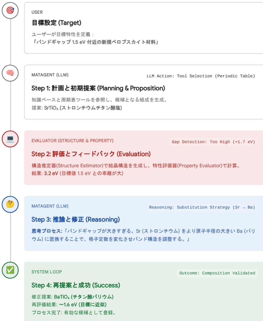
MatAgentによる自律的修正のプロセス例。目標値との乖離 (Gap) を認識し、化学的知識に基づいて次のアクション (置換、組成比変更) を決定している様子。
