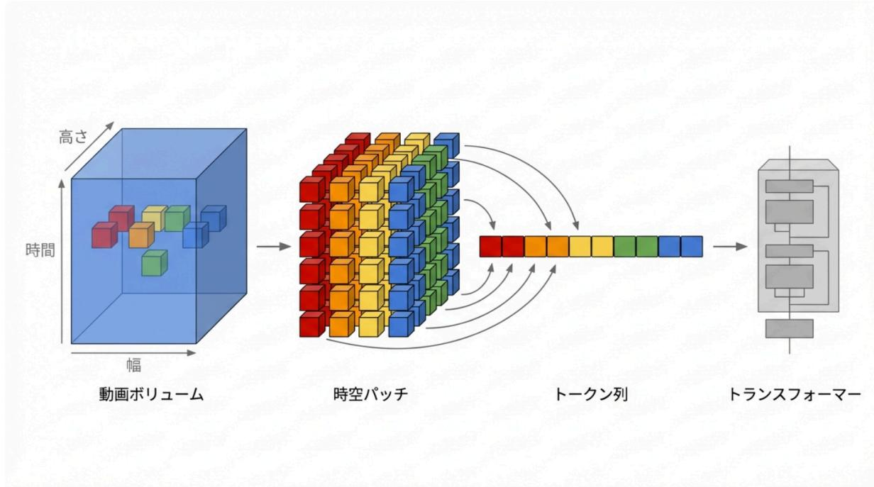
動画（左）は一連のフレームとしてではなく、時間軸（T）を含む3次元の直方体として扱われる。これを「時空パッチ」という小さな立方体に分割し、フラット化してTransformer（右）に入力する。これにより、空間的な位置関係と時間的な変化を同時に学習できる。
