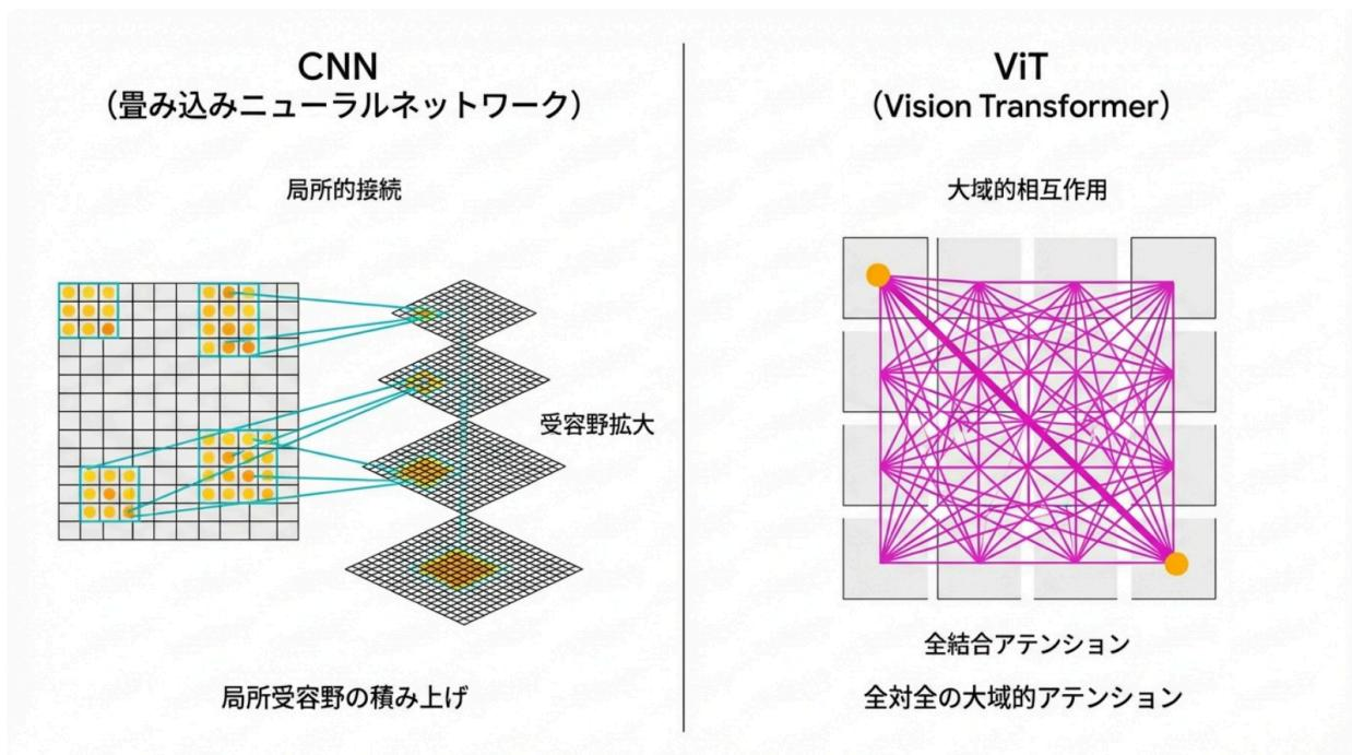
左 : CNNは局所的なフィルタ（例: 3x3）を適用し、層を重ねることで徐々に受容野を広げる。右 : ViTはSelf-Attentionにより、最初の層から画像内の離れたパッチ同士（例：空と地面）の関係性を捉えることができる。
