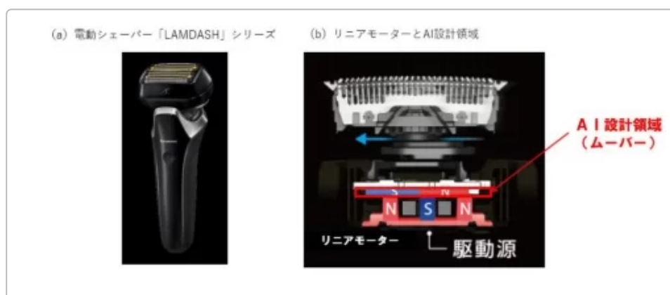
図：パナソニックにおける生成AI設計モーター（ラムダッシュ新モデルへの採用を検討） 21
